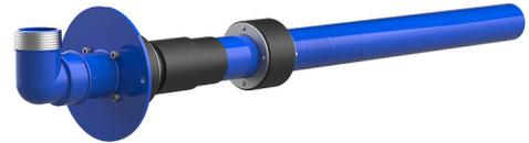
Wasser-Hauseinführungskombination Fabrikat Schuck DN 50 zum Einsatz in Kernbohrungen oder Futterrohre Øi 100 mm.
