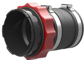
Des gaines passe-câbles lisses et annelées, d'un diamètre extérieur de 110, 125 ou 160 mm, peuvent être raccordées au couvercle HSI150 MA. Le raccordement de tuyau s'effectue en serrant une manchette en caoutchouc élastique et stable contre le couvercle et la gaine à l'aide de colliers de serrage en acier inoxydable.
