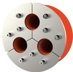
Le joint annulaire en caoutchouc individuel HRD LAU, approuvé par les autorités du bâtiment pour une utilisation dans les systèmes LAU, est utilisé pour étancher les câbles et les tuyaux dans les trous de carottage/les gaines.
