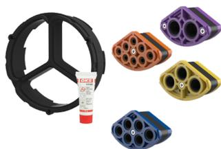
Les câbles sont étanchéifiés en douceur avec Technogel, matériau d'étanchéité utilisé avec les segments SEGMENTO. Quatre segments avec un champ d'application de 5 à 31 mm sont disponibles, qui sont montés dans le couvercle HSI150 S3 selon la combinaison souhaitée.
