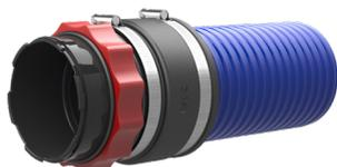
Le système d'entrée de câbles KES MA150 D est la solution idéale pour un système de gaines flexible et robuste. Le flexible spiralé Hateflex 14150 est raccordé au passage étanche HSI150 de manière étanche à l'eau et au gaz (2,5 bars) à travers le couvercle KES MA 150 D avec technique de manchons.
