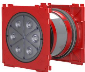
Les passages étanches double face sont disponibles à partir d'une épaisseur de paroi de 100 mm et munies de couvercles de fermeture étanches à la pression sur les deux côtés. Ils permettent de raccorder des gaines passe câble et de rendre les câbles étanches à l'intérieur du bâtiment.
