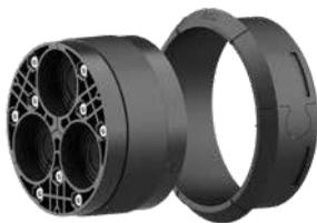
La cubierta del sistema HSI150 DG se instala después de que se hayan tendido los cables. De esta forma, toda la sección de la entrada del cable está disponible al tender los cables. Un anillo adaptador, que también está separado, asegura un ajuste de sellado óptimo.
