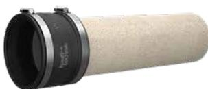
KES150 MA ZVR150/500 permite que la manguera espiral Hateflex pase a través del suelo de manera estanca al gas y al agua y ofrece un ajuste de sellado óptimo para sellos redondos. El ajuste exacto de la altura al nivel de piso acabado se realiza cortando la manga de pared revestida de cemento a la longitud deseada después del hormigonado.
