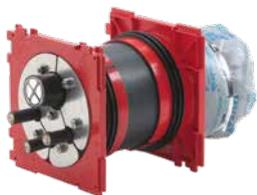
La protección contra incendios HSS150 HSI150 para paredes es una protección contra incendios estanca al gas y al agua con clase de resistencia al fuego S90 según la norma DIN 4102-9 para el montaje en el sistema HSI150 K2. El sistema se sella mediante una cubierta del sistema. La protección está homologada para cables de todo tipo en paredes y para la creación de paquetes con HSI150 hasta 2x6.
