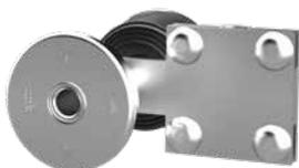
La entrada de derivación a tierra HEA PK tiene una resistencia a la torsión patentada a través del contorno especial del disco de contacto y es adecuada para el montaje con encofrado en hormigón a prueba de agua.
