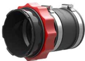
Con la cubierta del sistema HSI150 MA se pueden conectar canales de cables lisos y corrugados con un diámetro exterior de 110, 125 o 160 mm. La conexión de tubería se realiza mediante un casquillo de goma elástico y estable, que se presiona contra la cubierta del sistema y el canal de cables con correas de sujeción de acero inoxidable..
