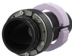
El sello de tubería corrugada WRD es la solución de sellado óptima para canales de cables corrugados. Los clips de anillo patentados garantizan una distribución uniforme de la presión de contacto y, con ello, aseguran un sellado cómodo sin que la goma sellante penetre en los ejes de la tubería. De esta forma, ni siquiera se pueden producir deformaciones o daños en la tubería corrugada.
