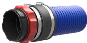
El sistema de entrada del cable KES MA150 D es la solución óptima para un sistema de tuberías vacías resistente a la presión, flexible y robusto. La manguera espiral Hateflex 14150 se conecta al inserto de pared HSI150 de forma estanca al gas y al agua (2,5 bar) a través de la cubierta del sistema KES MA150 D con método del casquillo.
