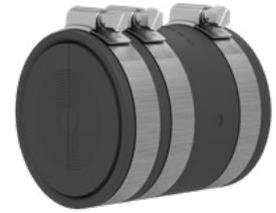
Abdichtset mit Manschette KES-M 90-WE inklusive geteiltem Wechseleinsatz mit Segmentringtechnik zur Abdichtung von Kabeln mit Gummipresstechnik am Ende des Hateflex-Spiralschlauches 14090.
