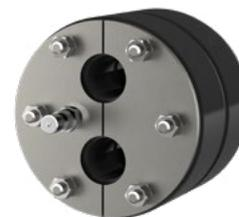
Individuelle Ringraumdichtung mit integriertem Prüfventil zur Überprüfung der Dichtigkeit ohne erhöhten Aufwand direkt nach der Montage und zur einfachen Fehlersuche bei Undichtigkeiten.
