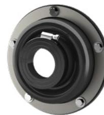
Zum Andübeln vor Kernbohrungen, Durchbrüchen oder Futterrohren an Wänden oder vor Aussparungen an Blechgehäusen. Systembedingt wird die vorhandene Kellerabdichtung ohne aufwändige Nachbearbeitung fachgerecht eingebunden. Gleichzeitig wird mit demselben Bauteil direkt das durchgeführte Medienrohr abgedichtet.
