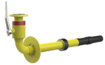
Gas-Hauseinführungskombination mit Gasarmatur Fabrikat Schuck DN 80 zum Einsatz in Kernbohrungen oder Futterrohren Øi 150 mm.
