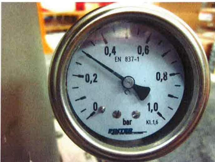
Abbildung A2: Druckdichtigkeitsprüfung der mit Wasser gefüllten Druckglocke bei Raumtemperatur und einem Nenndruck von 0,3 bar (oben: Manometerstand bei Versuchsbeginn am 31.10.2012 um 14:35 Uhr; unten: Manometerstand nach Versuchsende am 01.11.2012 um 14:35 Uhr)
