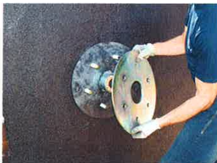
Abbildung 2.3: Montage des Losflansches
