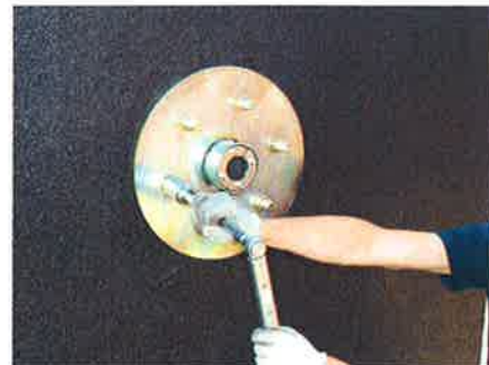
Abbildung 2.4: Anziehen der Muttern M20 (mit einem Drehmoment von 100 Nm)
