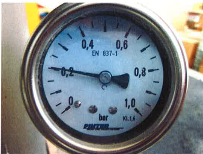
Abbildung A1: Druckdichtigkeitsprüfung der mit Wasser gefüllten Druckglocke bei Raumtemperatur und einem Nenndruck von 0,2 bar (oben: Manometerstand bei Versuchsbeginn am 30.10.2012 um 14:25 Uhr; unten: Manometerstand nach Versuchsende am 31.10.2012 um 14:25 Uhr)
