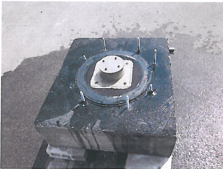
Abbildung 5: Flanschplatte mit HRD 150-F2-0 eingebaut
