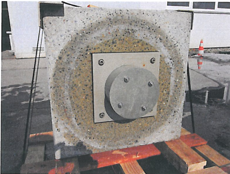
Abbildung 3: Flanschplatte mit HRD 150-2F-0 eingebaut
