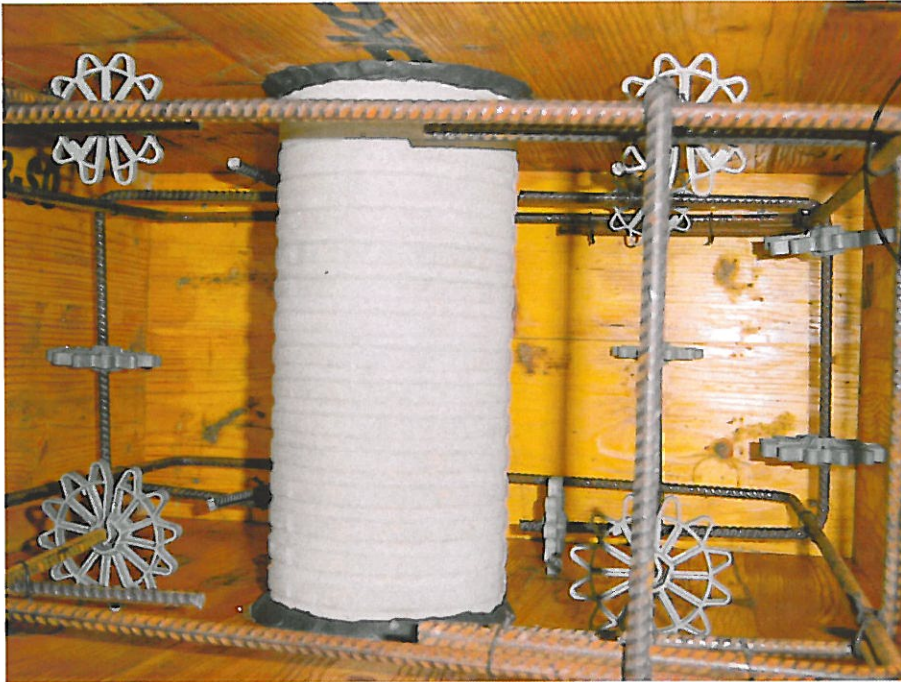
Bild 1: Horizontal ausgerichtetes FZR 100/300 Faserzement-Futterrohr vor dem Betonieren des Prüfkörpers
