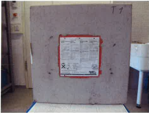
Abbildung 2. Beispiel für einen Prüfkörper mit einbetonierter Einfach-Dichtpackung Hauff HSI150-K/150.
