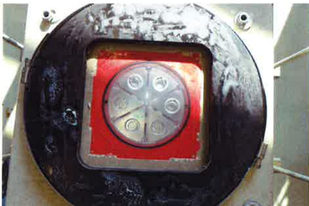
Abbildung 3. Prüfkörper mit einbetonierter Einfach-Dichtpackung Hauff HSI150-K/150 und Systemdeckel Hauff HSI150-DT.
