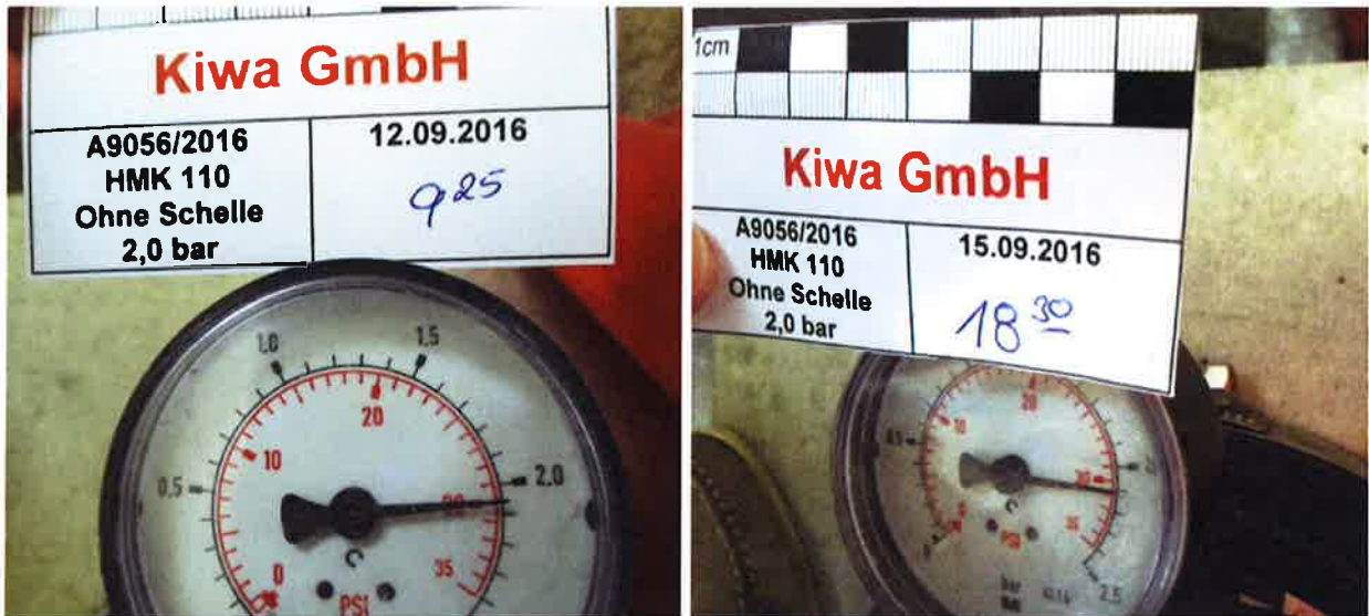
Abbildung A3. Druckdichtigkeitsprüfung der mit Wasser gefüllten Druckglocke bei einem Nenndruck von 2,0 bar (links: Manometerstand am 12.09.2016 um 9:25 Uhr; rechts: Manometerstand nach 3 Tagen am 15.09.2016 um 18:30 Uhr).
