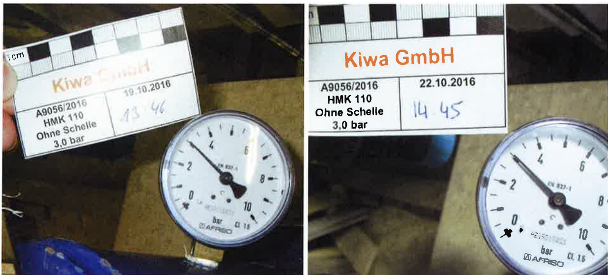
Abbildung A5. Druckdichtigkeitsprüfung der mit Wasser gefüllten Druckglocke bei einem Nenndruck von 3,0 bar (links: Manometerstand am 19.10.2016 um 13:46 Uhr; rechts: Manometerstand nach 3 Tagen am 22.10.2016 um 14:45 Uhr).
