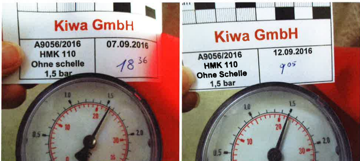
Abbildung A2. Druckdichtigkeitsprüfung der mit Wasser gefüllten Druckglocke bei einem Nenndruck von 1,5 bar (links: Manometerstand am 07.09.2016 um 18:36 Uhr; rechts: Manometerstand nach 4 Tagen am 12.09.2016 um 9:05 Uhr).
