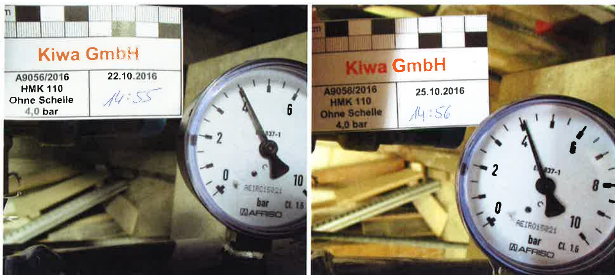
Abbildung A6. Druckdichtigkeitsprüfung der mit Wasser gefüllten Druckglocke bei einem Nenndruck von 4,0 bar (links: Manometerstand am 22.10.2016 um 14:55 Uhr; rechts: Manometerstand nach 3 Tagen am 25.10.2016 um 14:56 Uhr).
