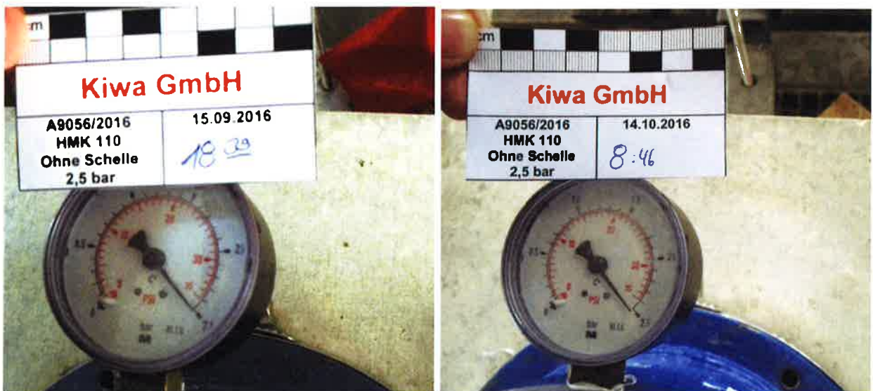
Abbildung A4. Druckdichtigkeitsprüfung der mit Wasser gefüllten Druckglocke bei einem Nenndruck von 2,5 bar (links: Manometerstand am 15.09.2016 um 18:39 Uhr; rechts: Manometerstand nach 29 Tagen am 14.10.2016 um 8:46 Uhr).
