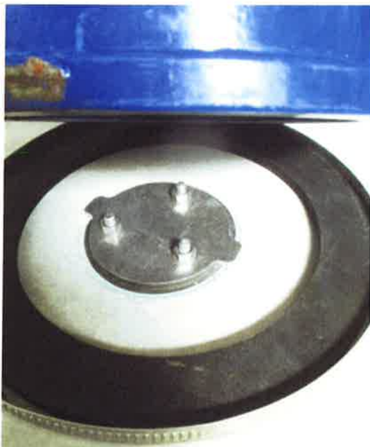
Abbildung 4. Beispiel für eine 40 mm dicke EPDM Dichtung.
