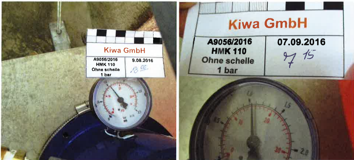
Abbildung A1. Druckdichtigkeitsprüfung der mit Wasser gefüllten Druckglocke bei einem Nenndruck von 1,0 bar (links: Manometerstand bei Versuchsbeginn am 09.08.2016 um 18:06 Uhr; rechts: Manometerstand nach 28 Tagen am 07.09.2016 um 7:15 Uhr).
