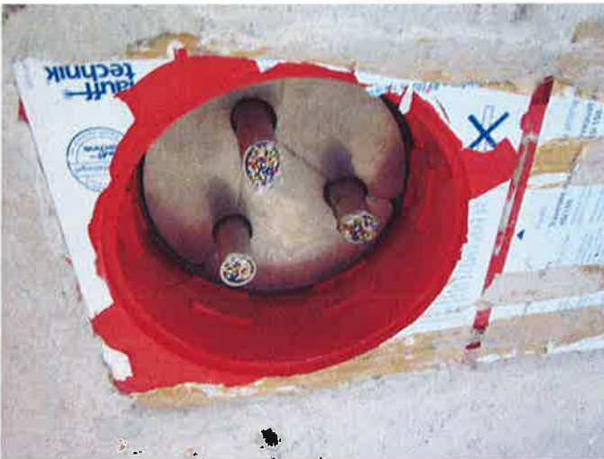
Abbildung 21: HSI 150 K2-100 mit HRD150/160-G-3/20 (NBR), Wannenunterseite nach 92 Tagen
