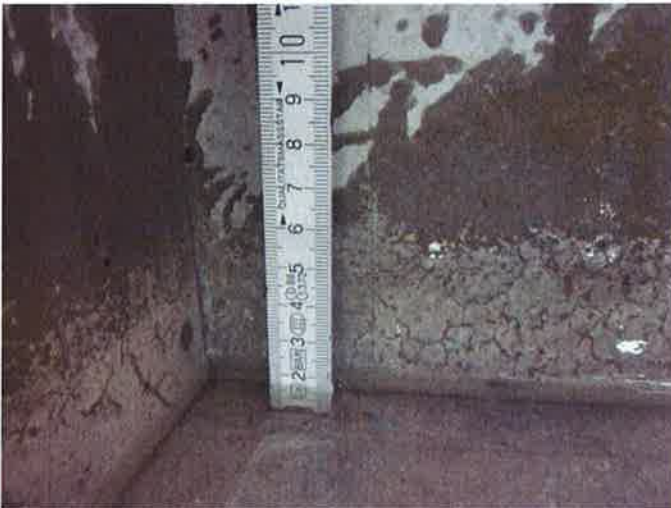
Abbildung 14: Ölstand in der Wanne unmittelbar nach dem Einbringen des Öls im Bereich der Einschüttstelle (ca. 16 mm)
