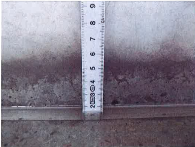
Abbildung 16: Ölstand in der Wanne bei Versuchsende nach 92 Tagen Ölbeaufschlagung im Bereich der Abdichtungsfuge (ca. 15 mm)
