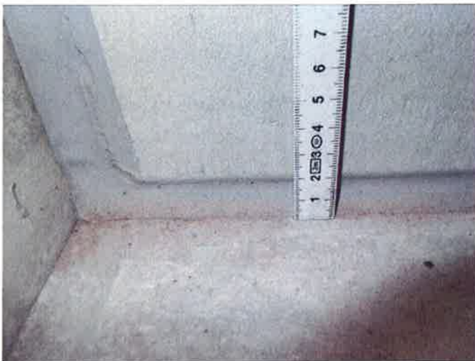
Abbildung 25: Abdichtungsfuge Sikaflex-Tank N auf der ölabgewandten Seite nach 92 Tagen
