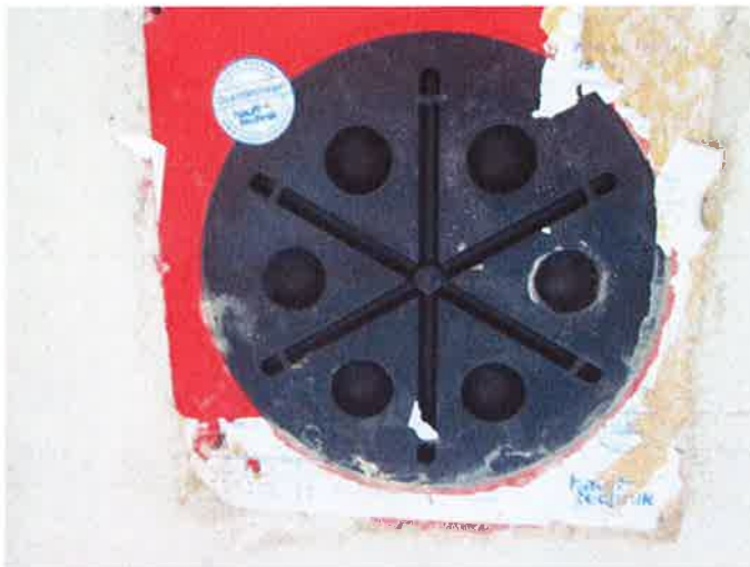
Abbildung 23: HSI 150 K2-100 mit Verschlussdeckel HSI 150-D (2. Versuch), Wannenunterseite nach 92 Tagen
