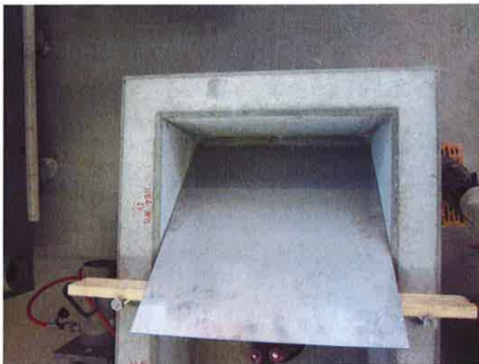
Abbildung 10: Stahlblech mit Bodenaussparrungen als Schütthilfe für das Einbringen des Öls
