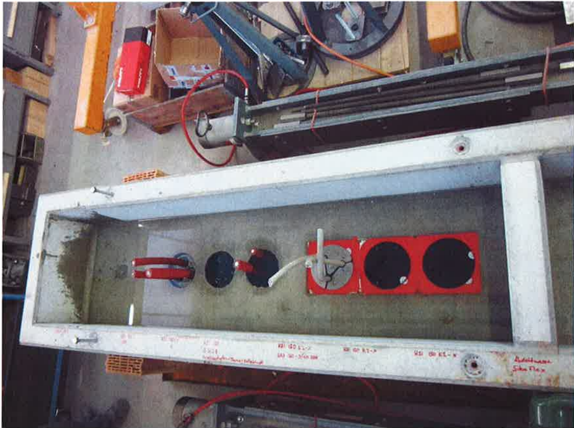
Abbildung 15: Fertig mit Isolieröl befüllte Betonwanne
