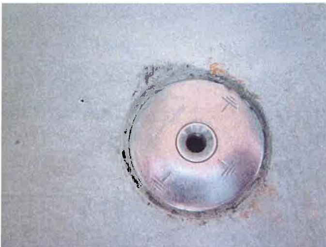
Abbildung 17: Erdungsdurchführung HEA-IS-M12/100, Wannenerunterseite nach 92 Tagen
