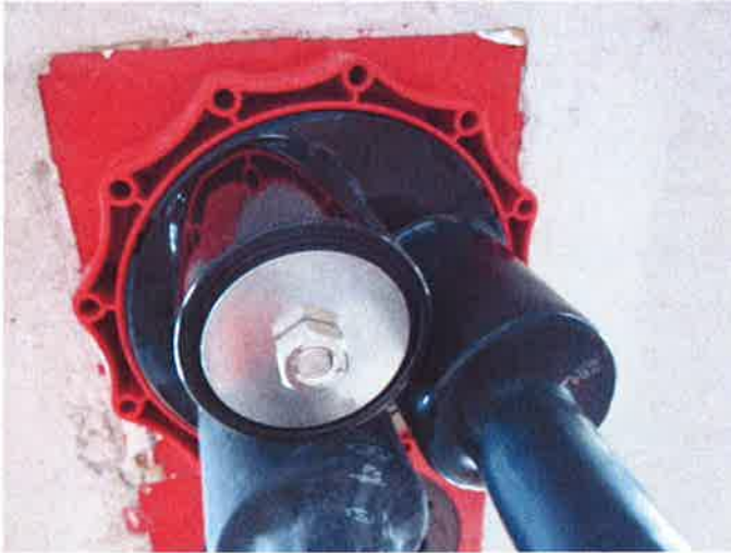
Abbildung 20: HSI 150 D3/58 mit Verschlussstopfen VS58/60, Thermo- und Kaltschrumpfmuffe in HSI 150-K 100, Wannenunterseite nach 92 Tagen
