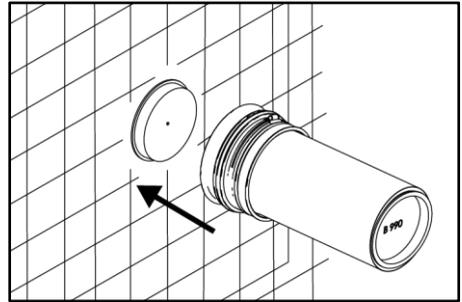
Das Futterrohr mit Klappmanschette auf dem befestigten Verschlussdeckel aufschieben und in der Innenschalung positionieren.
