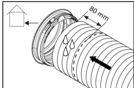
**5** Die Einstecktiefe (siehe Tabelle 1) am Kabelschutzrohr markieren. Das Kabelschutzrohr bis zur Markierung in die Klappmanschette schieben.
