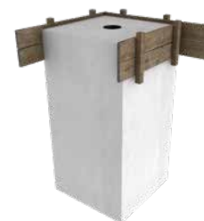
Fondazione cementata in loco
