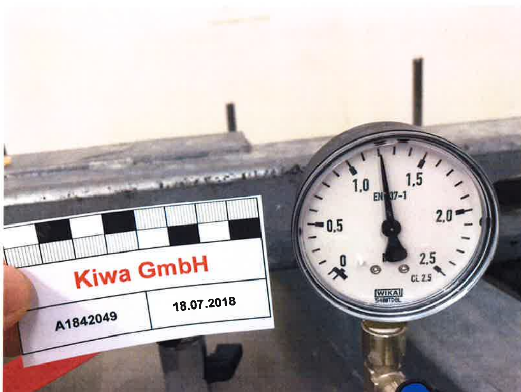
Abbildung A2. Druckdichtigkeitsprüfung der mit wassergefüllten Druckglocke bei einem Nenndruck von \geq 1 bar (Manometerstand nach 28 Tagen am 18.07.2018).
