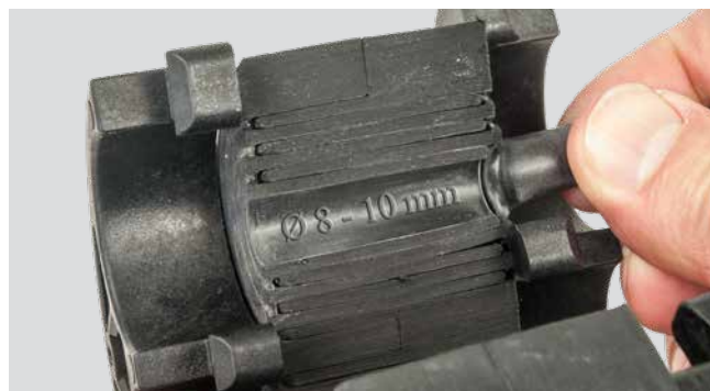
segments avec repérage précis des diamètres
