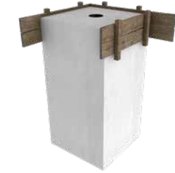
Fundament vor Ort betoniert
