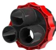
Les couvercles avec système à baïonnette sont installés dans les fourreaux étanches après la pose des câbles. Les couvercles HSI150 D1x80, HSI150 D3x58 et HSI150 D7x33 sont disponibles, selon les applications, pour assurer l'étanchéité des câbles. Livrés au choix avec manchon rétractables à chaud ou à froid. Les tubulures non utilisées peuvent être fermées avec des obturateurs VS.
