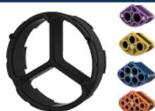
Quatre segments pour des câbles électriques de 5 à 31 mm peuvent être intégrés de façon aléatoire dans le couvercle segmenté HSI150 S3 à 3 sections. Ils sont livrables avec obturateurs et d'un gel d'étanchéité. Le Technogel utilisé assure la protection des câbles.
