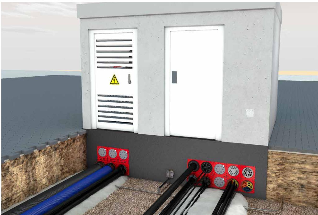
Différentes solutions pour l'étanchéité des câbles et le raccordement des fourreaux dans les postes de transformation accessibles.
