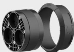
Le couvercle HSI150 DG est à installer après la pose des câbles. Une bague d'adaptation scindée assure une étanchéité optimale. L'insert d'étanchéité peut être adapté aux câbles posés sur le chantier grâce à la technique brevetée d'anneau super-segmenté détachables. Sur les segments les diamètres de câbles sont inscrits. Il permet l'ajustement de l'insert d'étanchéité aux différents diamètres de câbles. Quatre variantes de 10 à 112 mm sont disponibles.
