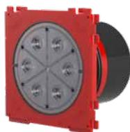
Les fourreaux à étanchéité simple sont utilisés surtout dans les milieux non accessibles pour l'étanchéité des câbles. Pour murs d'une épaisseur minimum de 70 mm. Ils sont équipés d'un couvercle de fermeture étanche à la pression et d'un couvercle de sécurité, qui sera retiré juste avant la pose des câbles. Cette double sécurité est une protection supplémentaire contre les infiltrations d'eau en cas d'ouverture accidentelle du couvercle de fermeture.
