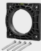
Une étanchéité superficielle en EPDM d'une épaisseur de 6 mm chevauche la paroi pour en assurer l'étanchéité. Les éléments de fixation avec rondelle étanche sont en acier inoxydable de haute qualité. Un niveau intégré permet de trouver plus facilement la position horizontale. Tous les couvercles et systèmes étanches HSI150 peuvent être intégrés.
