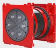
Les fourreaux à double étanchéité sont utilisés surtout dans les milieux accessibles pour l'étanchéité des câbles. Pour des murs d'épaisseur minimum de 100 mm. Ils sont équipés de chaque côté de couvercles de fermeture étanches à la pression avec système à baïonnette. Les gaines à double étanchéité permettent de raccorder des fourreaux électrique annelés ou lisses et d'apporter supplémentaire la possibilité d'étanchéfier les câbles.
