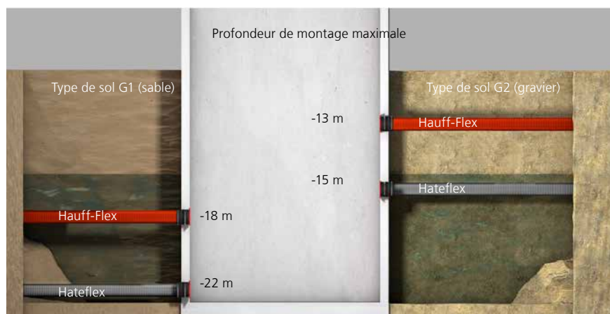
Profondeur de pose maximale des gaines de protection de câble
