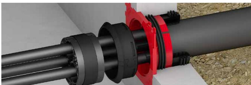
Bei einer geforderten Druckdichtheit bis 0,5 bar kann zum Anschluss von glatten Kabelschutzrohren die HSI150 GSM eingesetzt werden. Zur Kabelabdichtung wird auf der Gebäudeinnenseite ein Systemdeckel HSI150 DG installiert.
