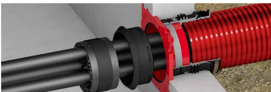
Bei einer geforderten Druckdichtheit bis 1 bar kann der Kabelschuttschlauch Hauff-Flex 150 eingesetzt werden. Der Gebäudeanschluss erfolgt über die HSI150 KMA. Zur Kabelabdichtung wird auf der Gebäudeinnenseite ein Systemdeckel HSI150 DG installiert.
