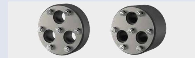
Verschiedene Dichtbreiten abhängig vom Einsatzort und der jeweiligen Wasserbeanspruchungsklasse. Dichtbreite 30 und 40 mm für WU-Beton Kernbohrungen oder Futterrohre. Weitere Lösungen auch in 60, 80 und 90 mm Dichtbreite erhältlich.
