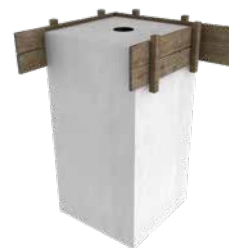
Fundament vor Ort betoniert
