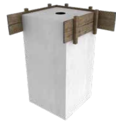
Fundament vor Ort betoniert
