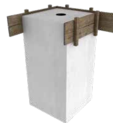
Fundament vor Ort betoniert
