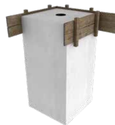
Fundament vor Ort betoniert
