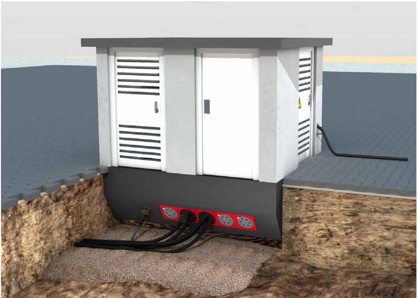
Anschlussbeispiel: Abdichtung von Mittelspannungskabeln (HSI150 D3x58), Steuer- und Signalkabeln (HSI150 D7x33) und Niederspannungskabeln (HSI150 D1x80). Anschluss eines Ringerders an die isolierte Erdungsdurchführung HEA IS M12.
