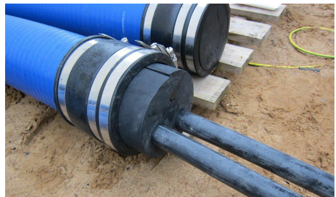
A KES150 MA WE160 SG SET mandzsetta vakdugóként és a spiráltömlő tömítéséhez is használható. Ennek során a szegmensgyűrű-technikával a helyszínen beigazítható az egyedi kábelátmérő.
