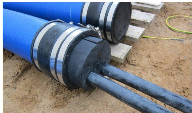
Komplet za brtvljenje s manžetom KES150 MA WE160 SG SET može se upotrijebiti kao slijepi čep te isto tako za brtvljenje spiralnog crijeva. Pritom se tehnikom segmentnih prstena može prilagoditi promjer kabela na licu mjesta.
