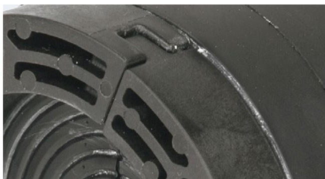
zazębiające się połączenie płyt dociskowych
