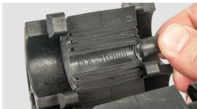
listki z dokładnym oznaczeniem średnicy kabla
