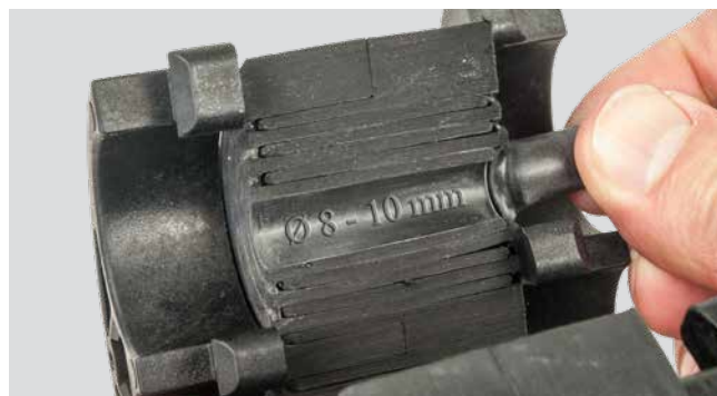
Segmente mit exakter Durchmesserbeschriftung
