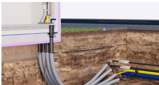
Eingebaute Mehrsparten-Hauseinführung MSH Basic FUBO SR4 EBT mit Dichteinsatz MSH Basic MBK R4, Leerrohrsystem Hafelex14078 MRD/x und den Sparten Wasser, Elektro, Kommunikation und Gas
