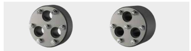
Verschiedene Dichtbreiten abhängig vom Einsatzort und der jeweiligen Wasserbeanspruchungskategorie. Dichtbreite 30 und 40 mm für WU-Beton Kernbohrungen oder Futterrohre. Weitere Lösungen auch in 60, 80 und 90 mm Dichtbreite erhältlich.
