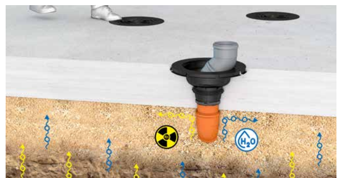
AT110 eingebaut in der Bodenplatte, absolut gas- und wasserdicht, mit der Möglichkeit zum Toleranzausgleich und zur Anbindung einer Dampfsperre
