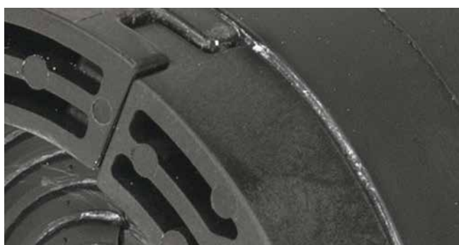
nauwe aansluiting van de drukplaten
