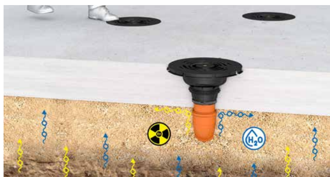
AT110 geïnstalleerd in de vloerplaat - slipvast en struikelvrij tijdens de bouwfase
