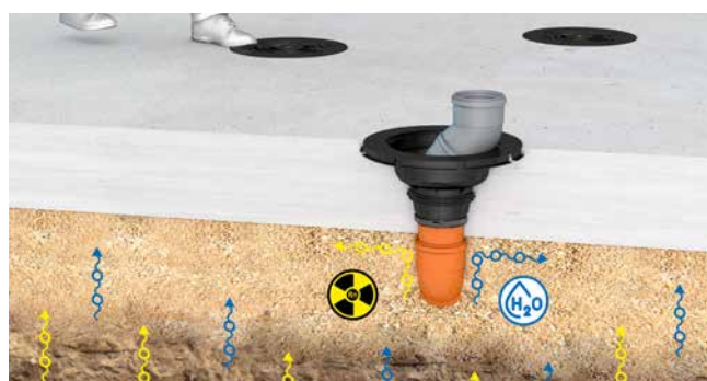
AT110 geïnstalleerd in de vloerplaat, absoluut gas- en waterdicht, met de mogelijkheid van tolerantiecompensatie en aansluiting van een dampscherm.
