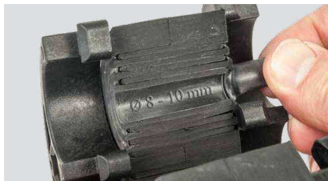
segment met exacte diameter opdruk
