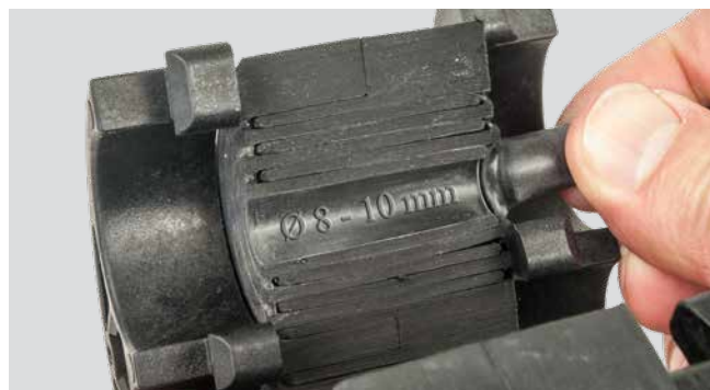
segment met exacte diameter opdruk
