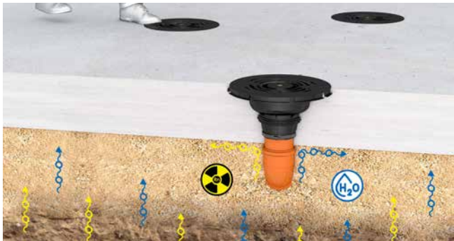
AT110 installé dans la dalle de sol - antidérapant et sans risque de trébuchement pendant la phase de construction
