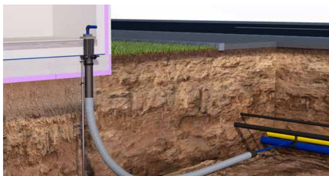
Entrée de service monoligne intégrée ESH Basic FUBO SR1 EBT avec insert d'étanchéité ESH Basic MBK SR1, système de gaines Hateflex14078 MRD/x et la division Eau
