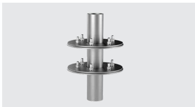
gaine en acier inoxydable avec 2 brides fixes/amovibles à cheviller sur toits plats isolés avec deux feuillards d'étanchéité selon DIN 18531
