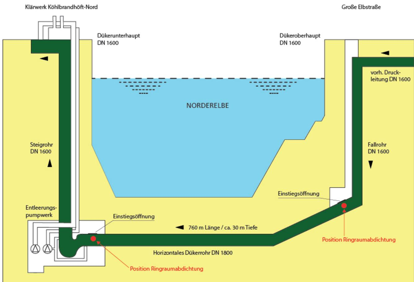
Kabelabdichtungen in 30 m Tiefe im Düker unmittelbar am Abwasserkanal unterhalb der Nordelbe
