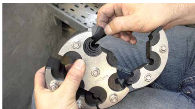
HRD150 SG 6x8-36 5 – ajuste flexible al diámetro del cable
