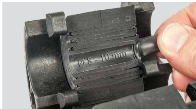
Segmentos con rotulación exacta del diámetro
