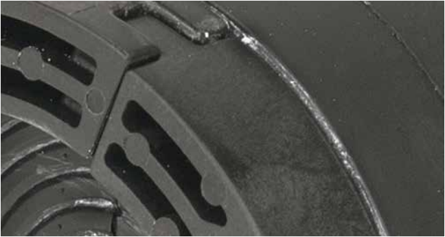
Placas de prensa con conexión de forma ajustada
