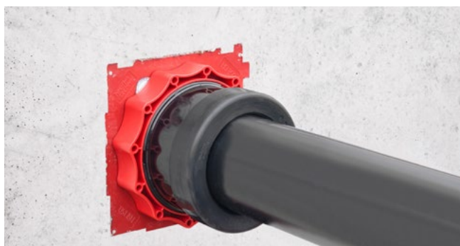
Anschluss eines starren Kabelschutzrohres DN 125 mit HSI150 D1x125 GSM
