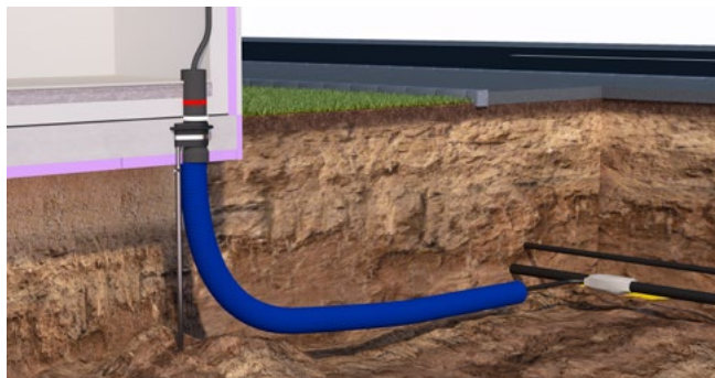
Eingebaute Einsparten-Gebäudeeinführung ESG100 FUBO EBT mit werkseitig verbundenem Leerrohrsystem Hateflex14110, eingebaute Ringraumdichtung HRK100 SSG 1x18-65 und der Sparte Elektro
