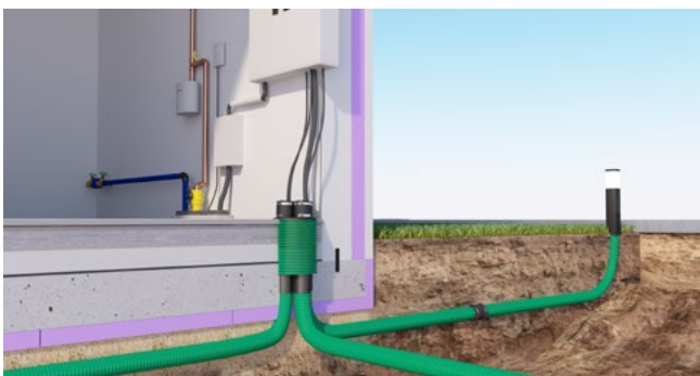
Eingebaute Hausausführung ETGAR Bauherrenpaket
