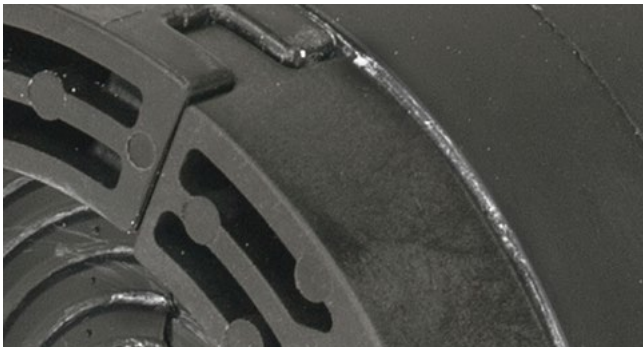
Pressplatten mit Formschlussverbindung
