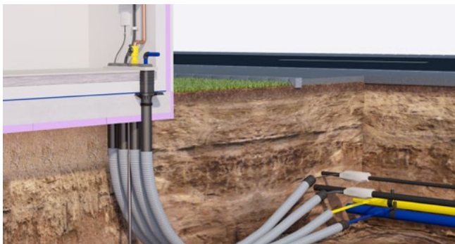
Eingebaute Mehrsparten-Hauseinführung MSH Basic FUBO SR4 EBT mit Dichteinsatz MSH Basic MBK R4, Leerrohrsystem Hafelex14078 MRD/x und den Sparten Wasser, Elektro, Kommunikation und Gas
