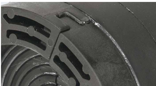
Pressplatten mit Formschlussverbindung
