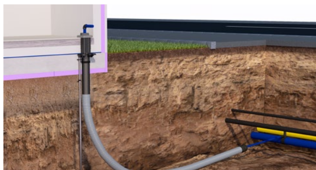
Eingebaute Einsparten-Houseinführung ESH Basic FUBO SR1 EBT mit Dichteinsatz ESH Basic MBK SR1, Leerrohrsystem Hateflex14078 MRD/x und der Sparte Wasser
