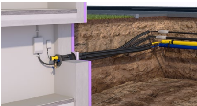
Eingebaute MSH PolySafe Grundvariante 1 mit Außendichtelement MSH PolySafe M6.2 mit angeschlossenem Leerrohrsystem und den Sparten Wasser, Elektro, Kommunikation und Gas.
