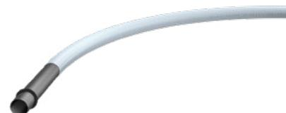
Für Ein- und Mehrspartenhauseinführungen zur Erstellung eines durchgängigen Schutzrohrsystems bis zu den Hauptversorgungsleitungen. Angeschweißtes Mantelrohr mit 3-Stegdichtung zum Anschluss an Grundkörper der Hauseinführung für Gebäude ohne Keller.
