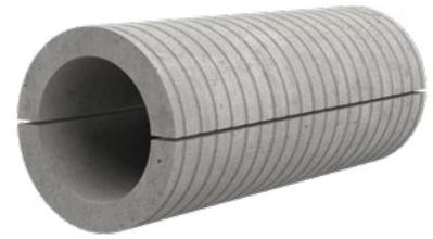
Bestehend aus zwei Halbschalen zur nachträglichen Abdichtung von bereits verlegten Medienleitungen. Zum Einbetonieren oder Einmörteln. Umlaufende Außenrillung gewährleistet einen dichten und kraftschlüssigen Verbund mit der Wand.
