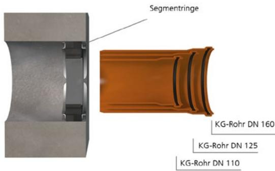
Mit der Ringraumdichtung HSD200 SSG 1x110/125/135/160 b40 A2/EPDM55 können die Standardrohre Øa 110, 125 und 160 abgedichtet werden.
