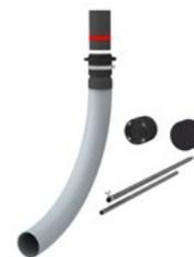
Bauherrenpaket XL als Einspartengebäudeeinführung für größere Mehrfamilienhäuser oder Industrie- oder Gewerbebauten. Zur Abdichtung größerer Leitungsdurchmesser für die Medien Strom, Wasser oder Gas bis DN50, mit flexiblem, druckdichtem und überbaubarem Leerrohrsystem.
