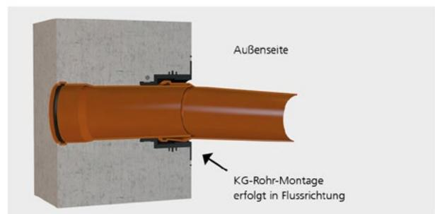
Bei herkömmlichen Wanddurchführungen in Doppelsteckmuffen-Ausführung wird die "Flussrichtung" durch das Einstecken des KG-Rohr-Spitzendes auf der Gebäudeaußenseite unterbrochen. Dies führt bei leichten Setzungen, die im Bereich des Arbeitsraumes nicht ganz ausgeschlossen werden können, zu einer "Stoßkante". Die Konsequenz: An der Kante bilden sich Ablagerungen, die über einen längeren Zeitraum zur "Verstopfung" des Abwassersystems führen können.
