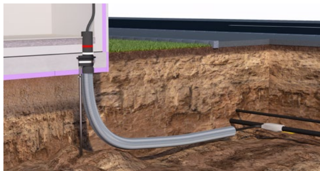
Eingebaute Einsparten-Gebäudeeinführung ESG100 FUBO EBT mit werkseitig verbundenem Leerrohrsystem Hatelflex141110, eingebauter Ringraumdichtung HRK100 SSG 1x18-65 und der Sparte Elektro
